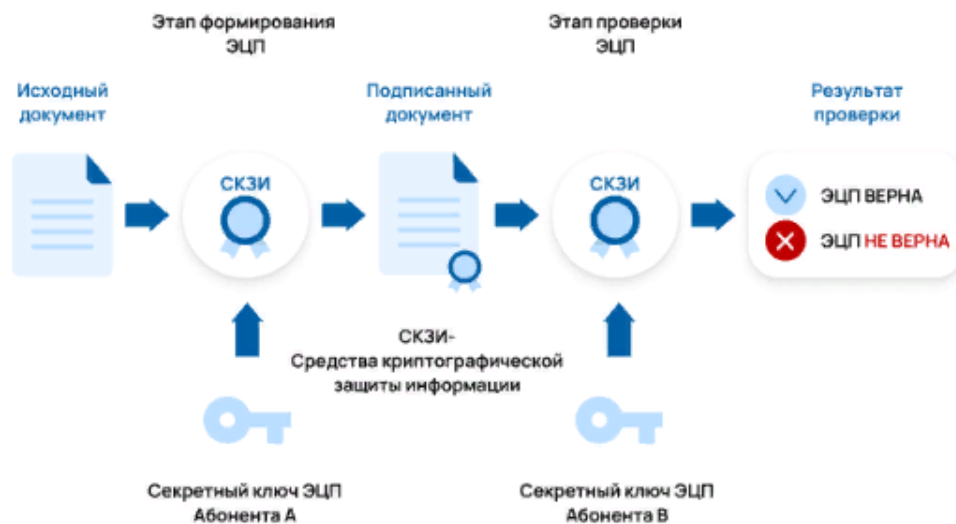
Сурет 1 - Электрондық цифрлық қолтаңбаның жұмыс істеу құрылымы
