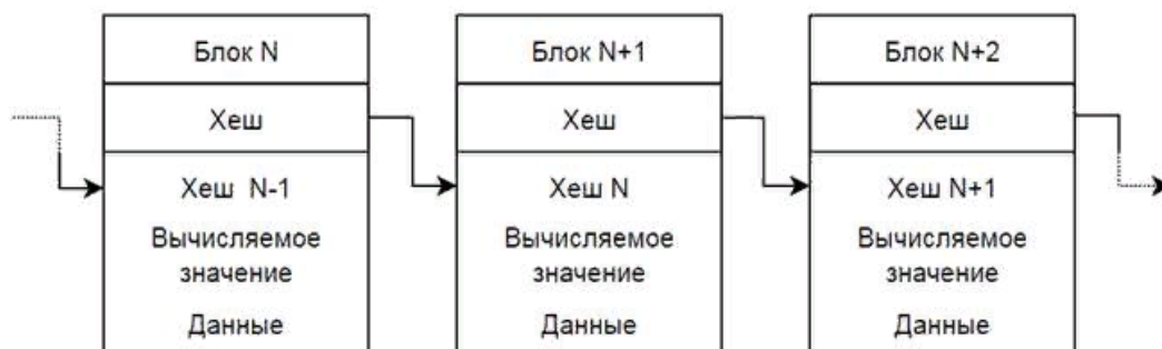
Сурет 1 - Блоктар тізбегінің және олардың байланысының жалпы схемасы
